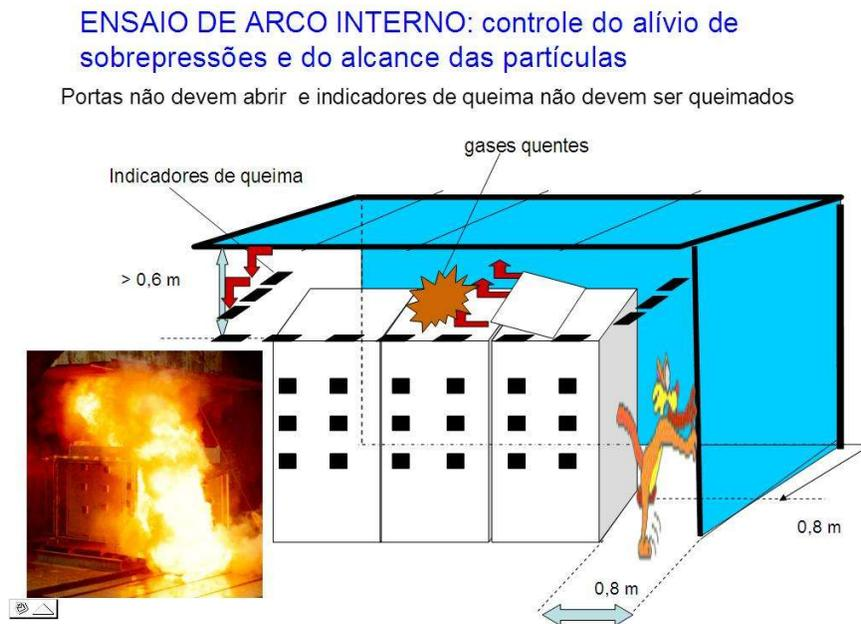
A simulação do ensaio de arco interno é uma tarefa complexa, pois envolve a necessidade de desenvolver não apenas um modelo competente de arco, mas também para trabalhar com dinâmica de fluidos no nível de fluidos compressíveis. Do ponto de vista de comparar os resultados dos testes com os resultados da simulação, existem dois critérios principais para ser aprovado nos testes:
